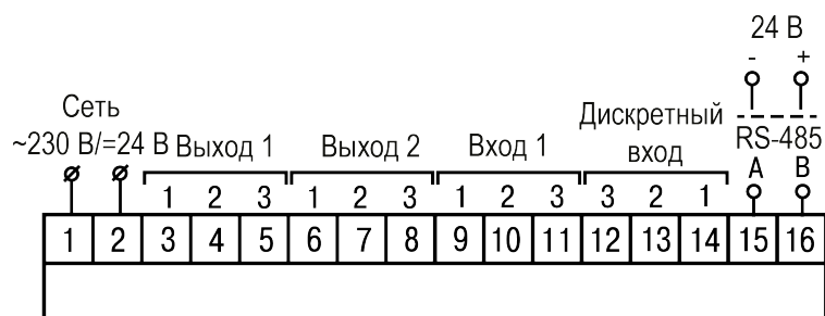
Рисунок 5.7 – Общая схема подключения TPM10–Н
