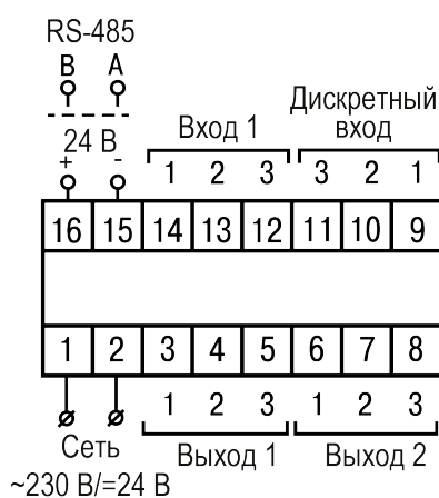
Рисунок 5.5 – Общая схема подключения TRM10–Щ5
