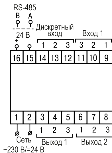
Рисунок 5.6 – Общая схема подключения TRM10–Д
