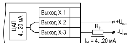
Рисунок 5.26 – Подключение к ВУ типа «И»
