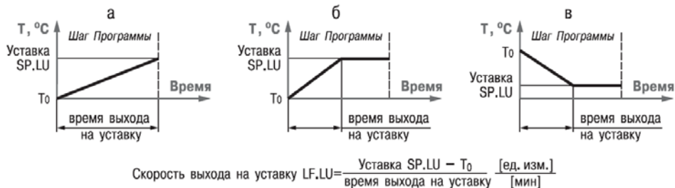
Рисунок 3.6 – Задание скорости выхода на Уставку
