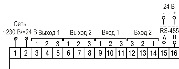
Рисунок 5.7 – Общая схема подключения ТРМ12–Н
