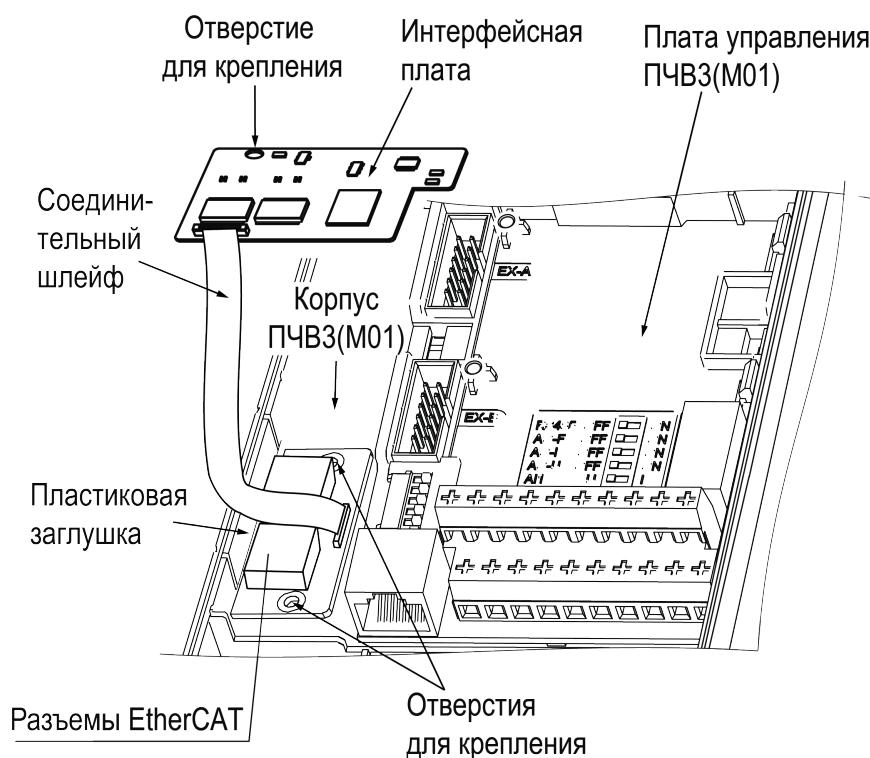
Рисунок 3.2 – Монтаж платы на преобразователях частоты мощностью 5,5 – 45 кВт
