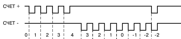
Рисунок 6.2 – Принцип работы входов «Счет+» и «Счет-»
