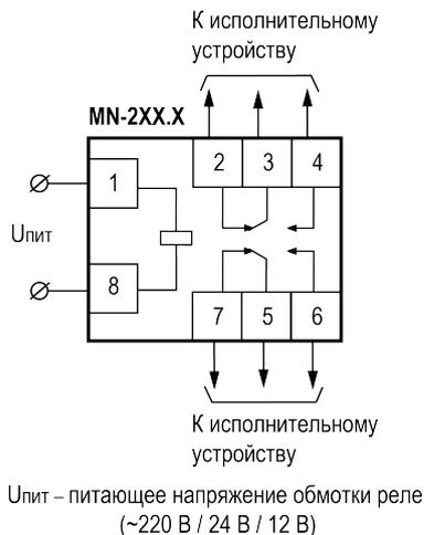
**Рисунок 6.1 – Схема подключения реле исполнения MN-2XX.X**
