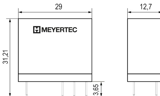
Рисунок 5.1 – Габаритные размеры реле исполнений MN-2XX.X
