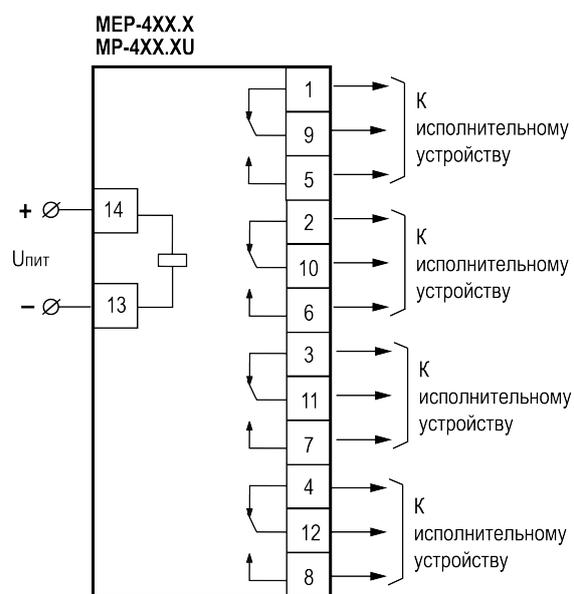
MEP-4XX.X: Uпит – питающее напряжение обмотки реле (~220 В / 24 В)
