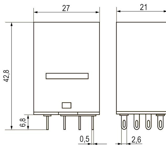
**Рисунок 5.4 – Габаритные размеры реле исполнений МЕР-4XX.XU**
