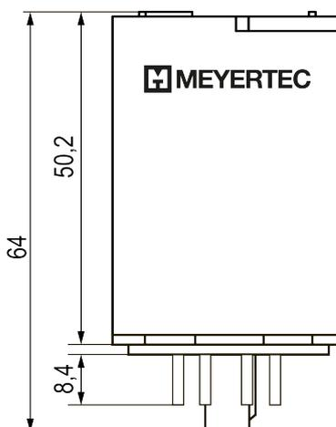
Рисунок 5.2 – Габаритные размеры реле исполнений NS-3XX.XU
