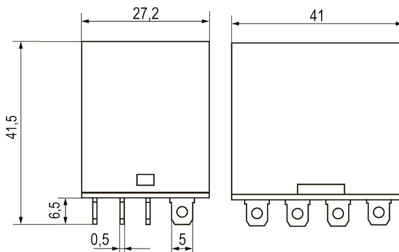
**Рисунок 5.3 – Габаритные размеры реле исполнений МЕР-4XX.X**
