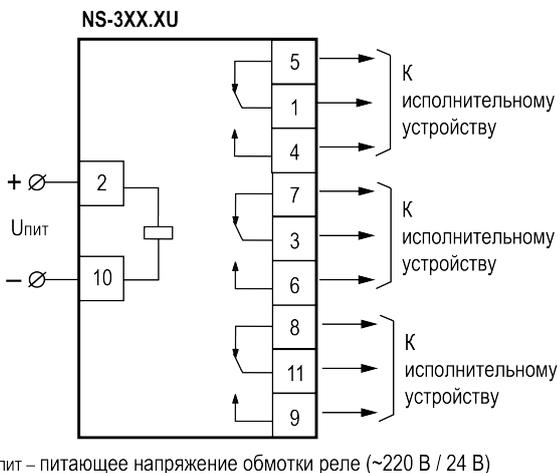
**Рисунок 6.2 – Схема подключения реле исполнения NS-3XX.XU**
