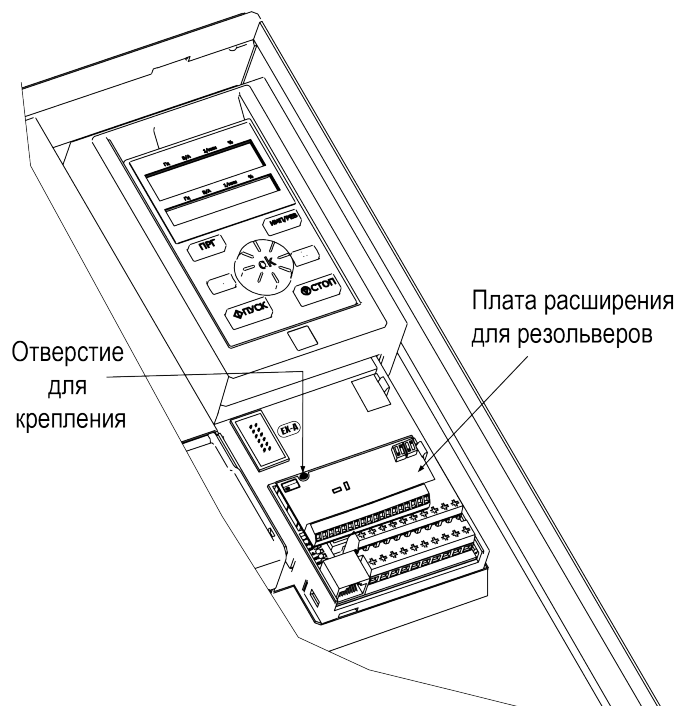
Рисунок 4.1 – Монтаж платы расширения для резольверов
