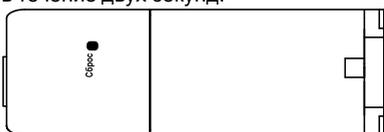
**Рисунок 3 – Кнопка «Сброс» на нижней стороне корпуса**
